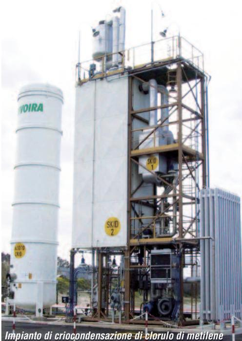
Impianto di criocondensazione di cloruro di metilene
