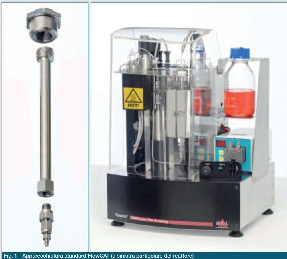
Fig. 1 - Apparecchiatura standard FlowCAT (a sinistra particolare del reattore)
