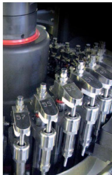
La dosatrice è equipaggiabile con differenti sistemi di controllo peso MG2, tra cui il nuovo MultiNett integrato che controlla in tempo reale il peso netto dosato nel 100% delle capsule prodotte.
