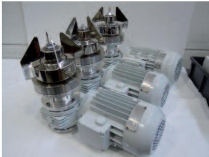
**Aerrexinox** presenta l'agitatore magnetico, realizzato in accordo alle cGMP ed è indicato soprattutto per le applicazioni nel settore farmaceutico, delle biotecnologie e cosmetico. Poiché non esiste 'un albero passante' e quindi una tenuta meccanica, non c'è rischio di contaminazione con l'ambiente esterno, rendendo molto vantaggiosa l'applicazione nella preparazione di prodotti tossici e sterili. L'agitatore è lavabile (C.I.P.) e sterilizzabile
