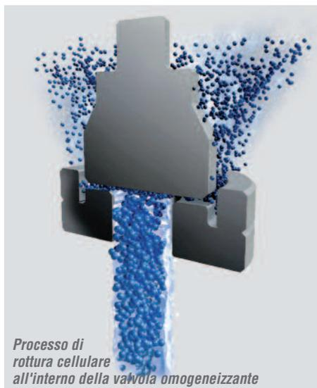
*Processo di rottura cellulare all'interno della valvola omogeneizzante*
