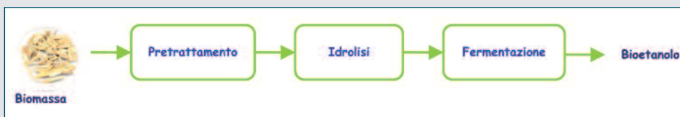
Schema 1 - Fasi principali nella produzione di bioetanolo
