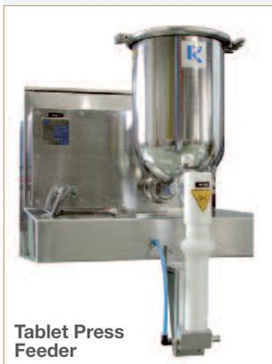
Il dosatore **K-Tron** per il lubrificante nelle applicazioni sulle compresse è un dispositivo bi-vite, in esecuzione farmaceutica, insieme a un sistema pneumatico che esegue l'aspirazione del lubrificante (normalmente magnesio stearato) direttamente alla compresse.
