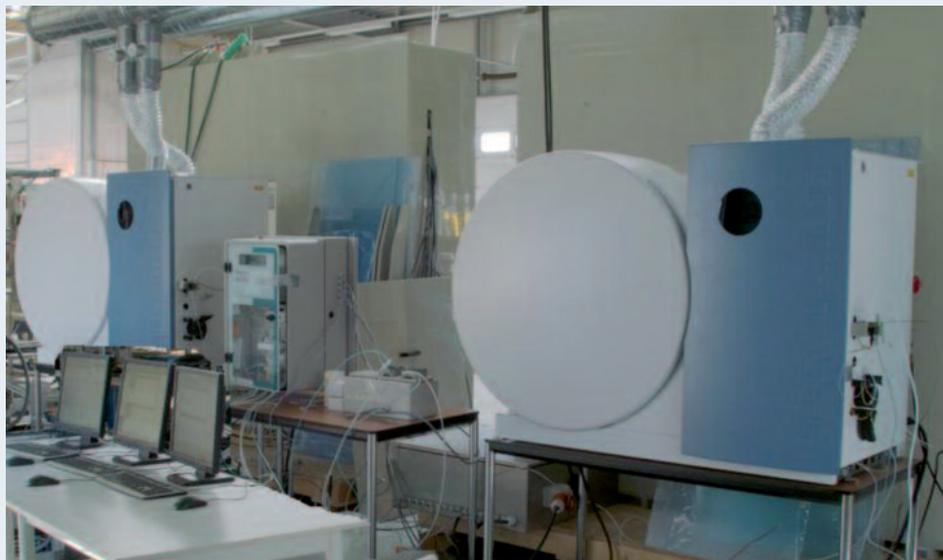
*I due spettrometri ICP SPECTROARCOS permettono di analizzare 24 ore su 24 i campioni provenienti dal processo produttivo industriale*
