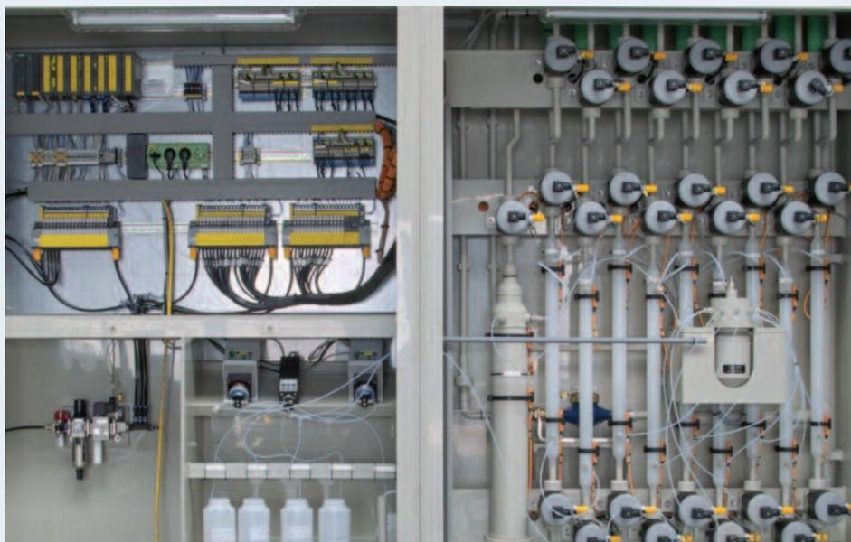
*Il sistema di elettrovalvole permette di indirizzare il flusso del campione da analizzare verso il sistema analitico*
