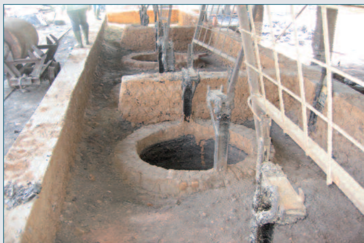
Fig. 2 - Le vecchie "caldaie" per la fusione del bitume naturale di Selenizza
