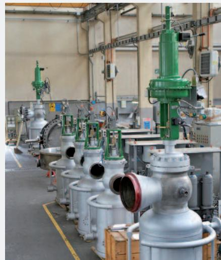
Valvole di by-pass turbina in approntamento
