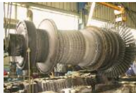
Parti statoriche e ruote ad azione turbina nello stabilimento di Ravenna
