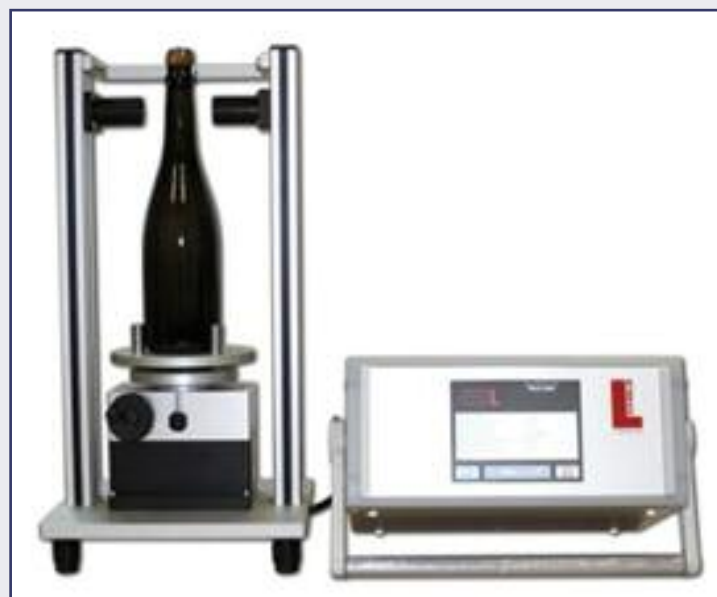
Fig. 1 - Afrometro elettronico per la misura di CO 2 in bottiglie di vino
