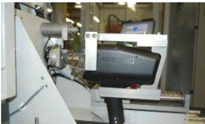
Grazie alla sonda di misura dello Spectrotest lo spettrometro è in grado di raggiungere facilmente il materiale da controllare
