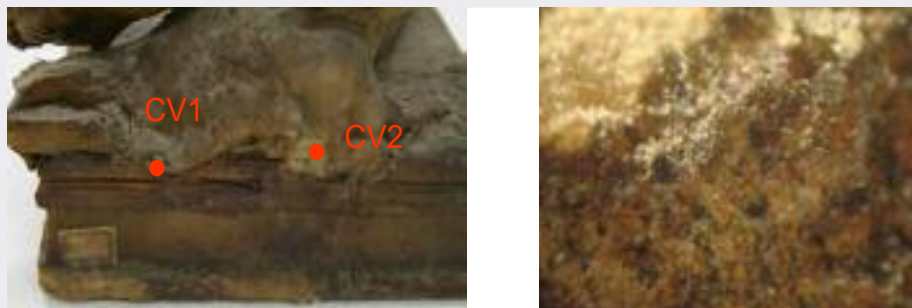
Fig. 2 - Punti di prelievo dei campioni CV1 e CV2 e fotografia allo stereomicroscopio (x450) della superficie del campione CV1
