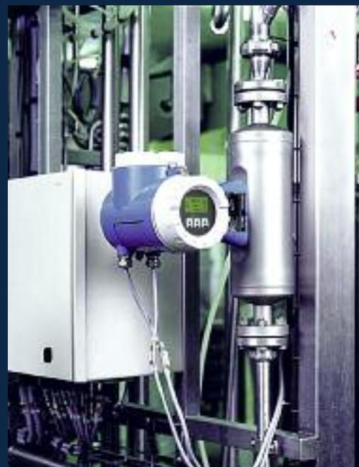
Misuratore di portata massica Coriolis monotubo Promass I basato su sistema brevettato TMB
