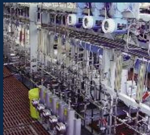
Miscelazione e dosaggio di fluidi mediante misuratori di portata massica Promass A
