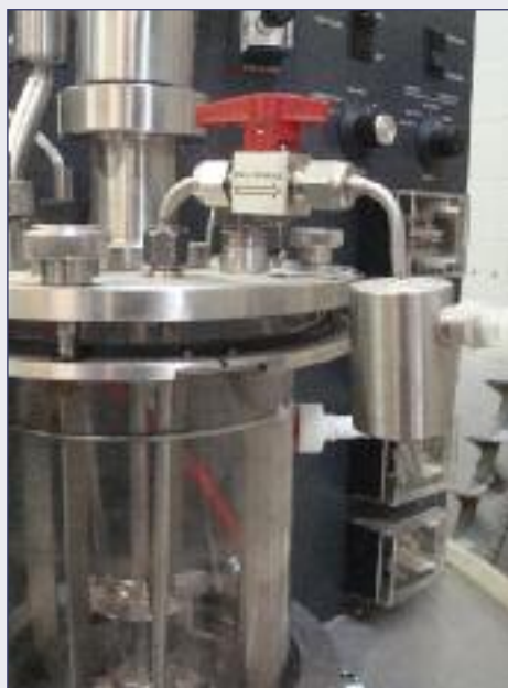
Fermentatore per la produzione di n -butanolo
