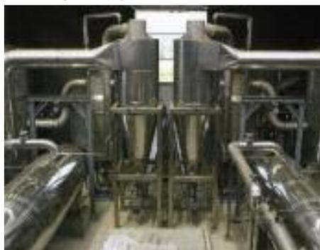
rarsi il vapore che viene allontanato forzatamente, per aspirazione, dal modulo di essiccazione. La separazione delle particelle solide avviene in un sistema ciclonico per differenza gravimetrica. In alcune esecuzioni specifiche, invece, il vapore viene allontanato per aspirazione dall'albero cavo del turbo-agitatore e il materiale secco scaricato dalla bocca di uscita.
