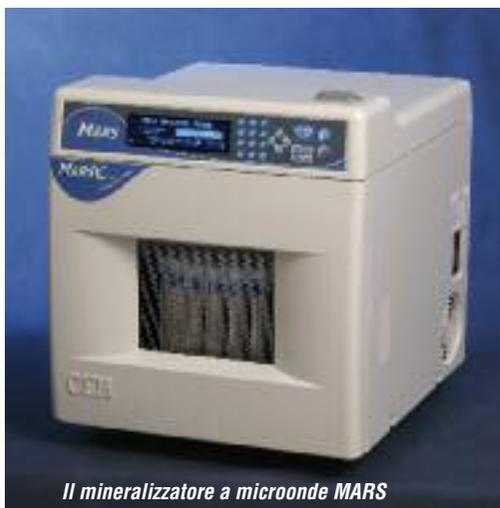
Il mineralizzatore a microonde MARS
