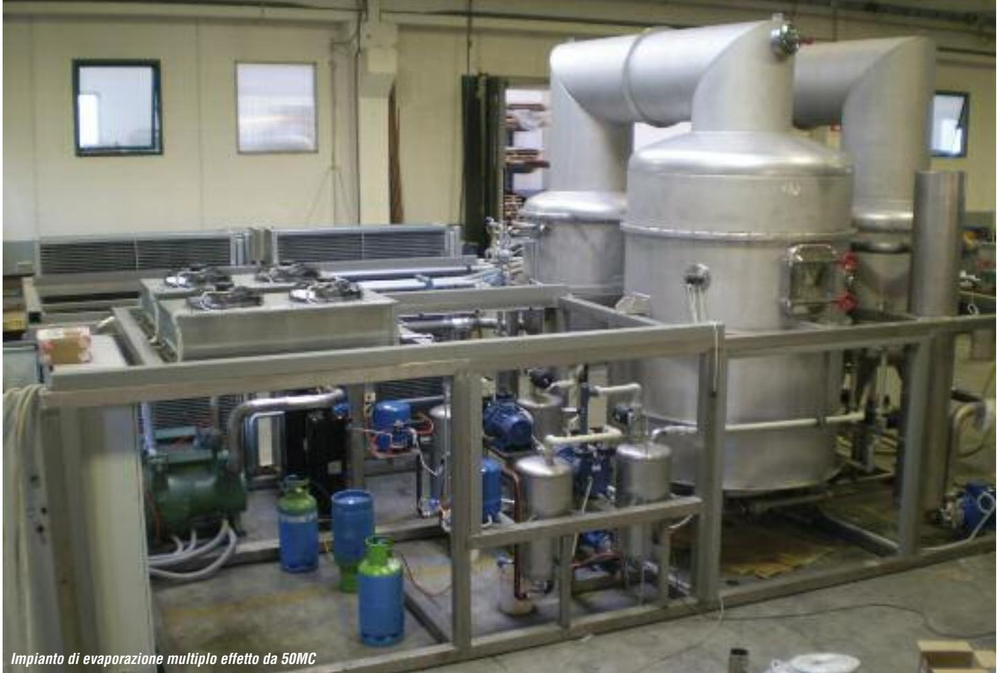
Impianto di evaporazione multiplo effetto da 50MC
