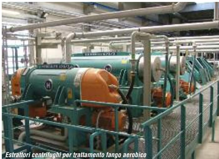
Estrattori centrifughi per trattamento fango aerobico
