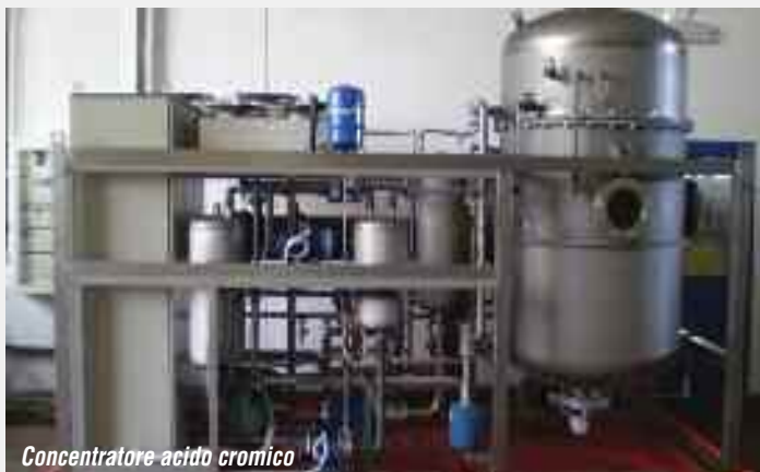
Evaporatore pompa di calore 48 mc-d
