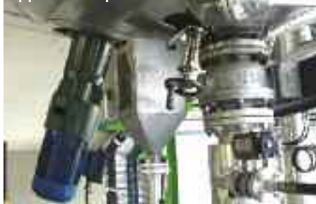
Applicazione tenuta doppia a cartuccia su agitatore Top Entry
