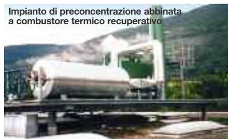
Impianto di preconcentrazione abbinata a combustore termico recuperativo
