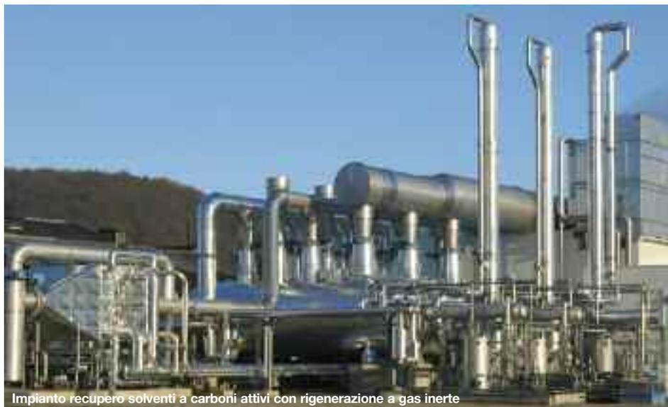
Impianto recupero solventi a carboni attivi con rigenerazione a gas inerte
