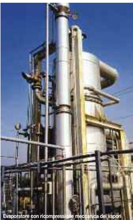
Evaporatore con ricompresse meccanica dei vapori
