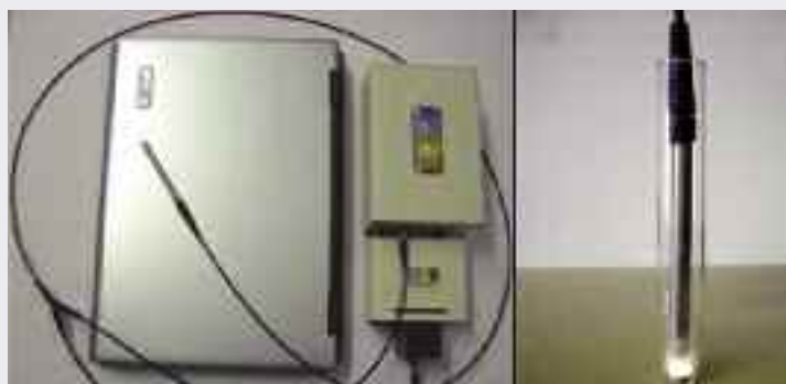
Strumentazione per spettrometria NIR-DAD in riflettanza. Le dimensioni del PC portatile danno idea delle dimensioni dell'intero assetto strumentale. La fotografia di destra mostra in dettaglio l'assetto geometrico durante l'acquisizione degli spettri nel presente lavoro
