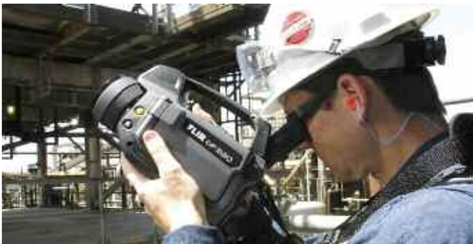
Tre anni fa venne lanciata la prima termocamera di **FLIR** per l'analisi perdite gas ed oggi, per molte aziende, le termocamere ad infrarossi di questa famiglia rappresentano un sistema unico. Tali termocamere hanno portato inoltre numerosi vantaggi a queste aziende nell'ambito dell'attenzione al rispar-
