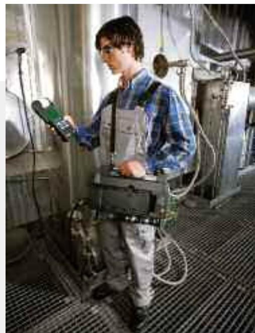
tooth. Il trasferimento wireless dei dati permette di superare facilmente distanze fino a 100 m (in campo aperto) tra l'unità operativa e l'analizzatore per gas combustibili anche negli impianti più grandi, rendendo superflui i collegamenti diretti di cavi.
