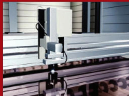
**High Speed TRR: particolare che mostra la combinazione di spettrometri diodi array VIS/NIR serie CORONA PLUS (campo spettrale da 300nm a 1680) cui sono collegate via fibra ottica le teste di misure per trasmittanza/riflettanza spettrali**
