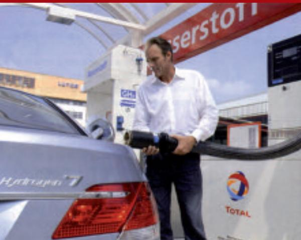
Stazione di rifornimento in Germania con una pompa ad accoppiamento ermetico per idrogeno liquido
