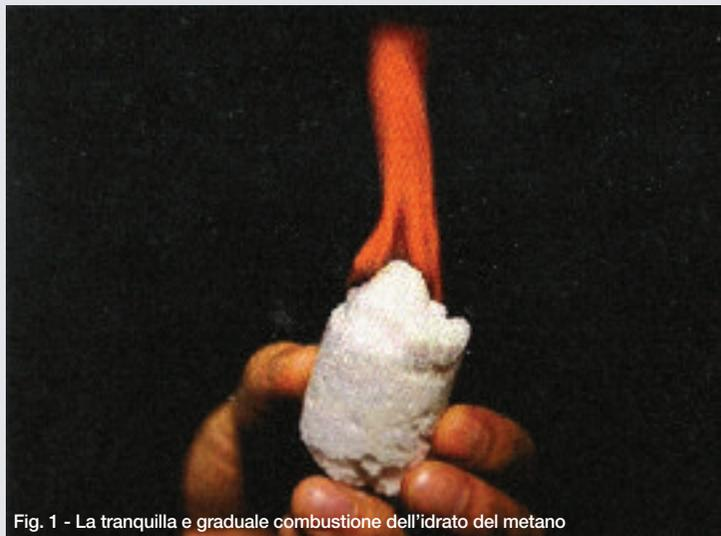
Fig. 1 - La tranquilla e graduale combustione dell'idrato del metano
