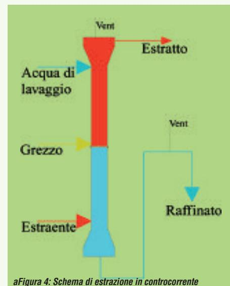
aFigura 4: Schema di estrazione in controcorrente
