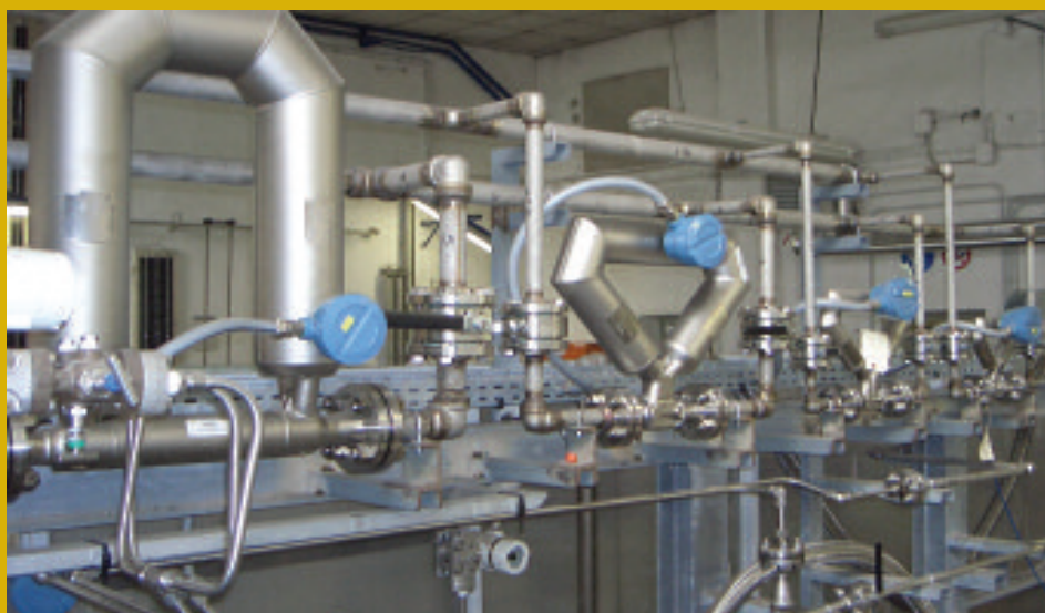
Il banco di prova calibrazioni per strumenti di portata gas
