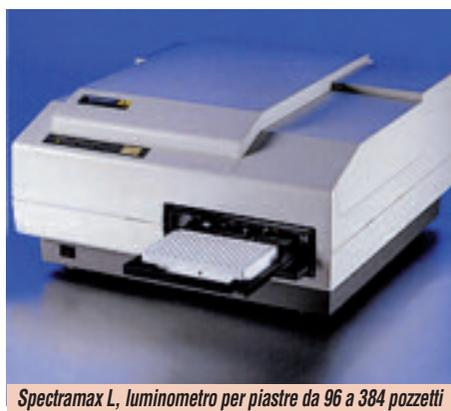
**Spectramax L, luminometro per piastre da 96 a 384 pozzetti**
