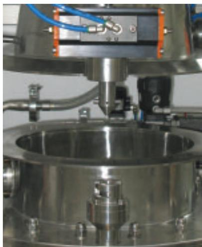
fettamente le superfici che rimarranno esposte all'ambiente. Test effettuati sul sistema di carico provvisto di dispositivo C.I.P. di lavaggio ed asciugatura hanno dimostrato una concentrazione residua di contaminante inferiore a 0.09 p.p.m. (in pieno accordo alla normativa FDA che, per considerare un impianto pulito, prevede un valore inferiore a 10 p.p.m.).
