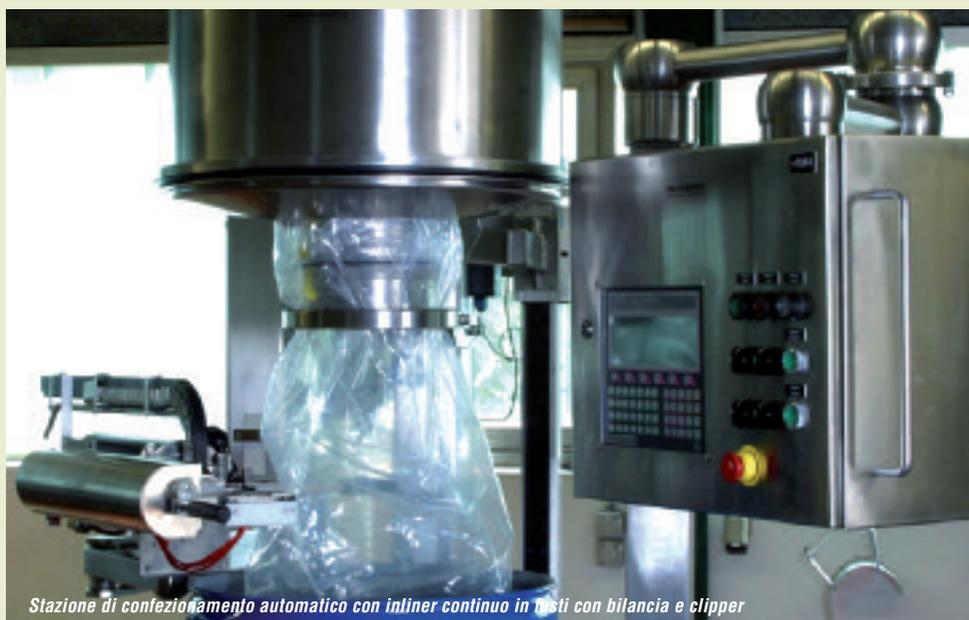
*Stazione di confezionamento automatico con inliner continuo in fusti con bilancia e clipper*
