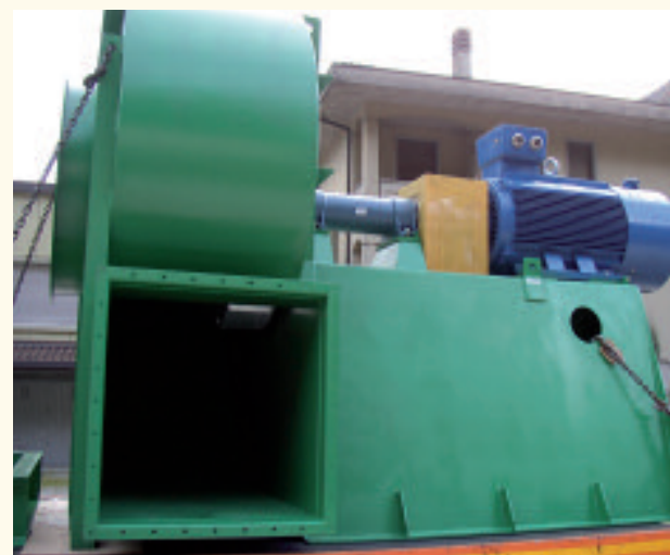
Ventilatore con motore da Kw 160
