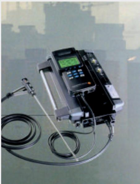
*Il sistema portatile per l'analisi delle emissioni 350 S/XL*
