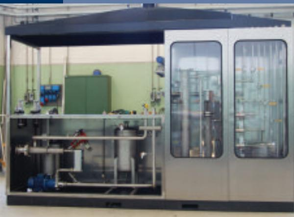
merizzazione dell'inchiostro su diversi supporti come, ad esempio, PVC, PP, PE e legno. SIAD ha messo a punto un nuovo sistema, in cui l'essiccamento degli inchiostri UV avviene in atmosfera inerte di azoto e pertanto la presenza di ossigeno viene pressoché eliminata: grazie all'impiego di questa tecnologia l'energia prodotta è sfruttata al 100%.
