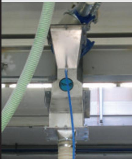
Il dispositivo gravimetrico per controllo di portata e dosaggio di solidi e granulari C-LEVER
