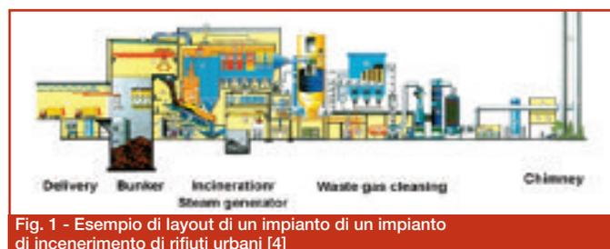
Fig. 1 - Esempio di layout di un impianto di incenerimento di rifiuti urbani [4]
