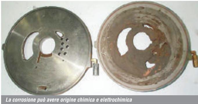
pila, il quale, se si chiude il circuito, provoca un passaggio di corrente elettrica. Pile di questo genere possono formarsi in più maniere, a seconda dei diversi accoppiamenti metallo-elettrolita.
