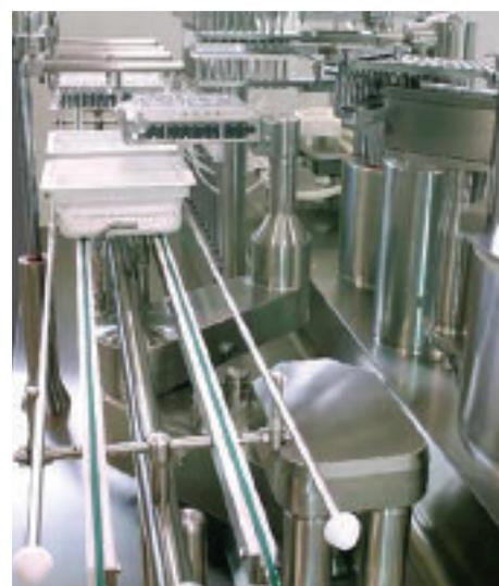
*La FSP10 Co.Ri.M.A. che prevede il riempimento siringhe con liquido sterile e tappatura tramite rubbers stopper*
