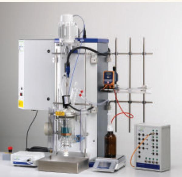
Calorimetro di reazione RC1e Metter Toledo
