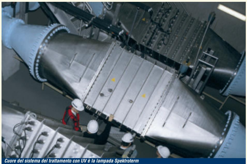
**CUORE DEL SISTEMA DEL TRATTAMENTO CON UV È LA LAMPADA SPEKTROTERM**
