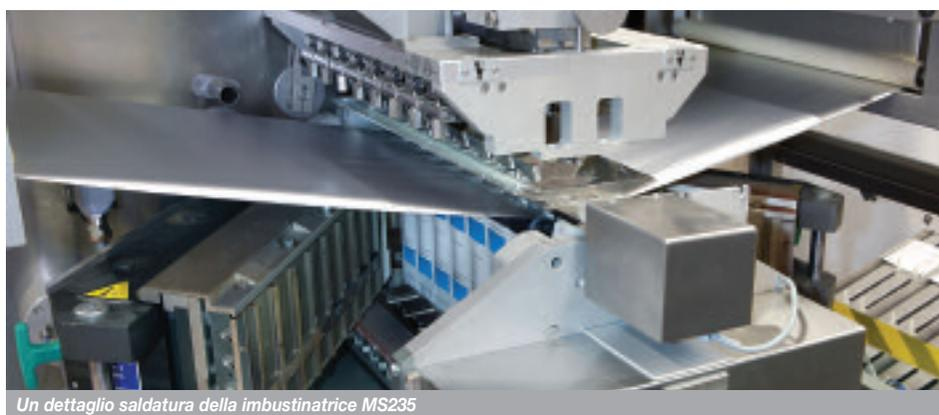
Un dettaglio saldatura della imbustnatrice MS235
