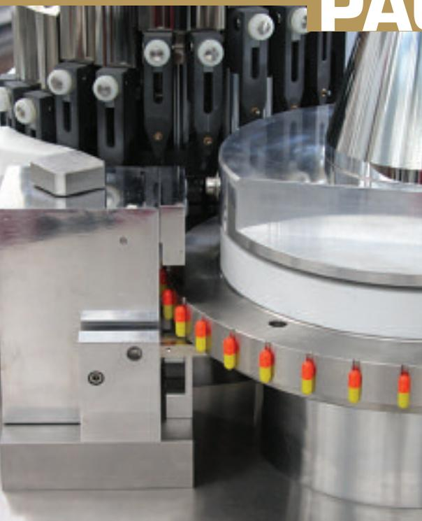
NETT - Sistema di controllo del peso di tutte le capsule dosate, integrato alla opercolatrice, con autoregolazione delle camere di dosaggio
