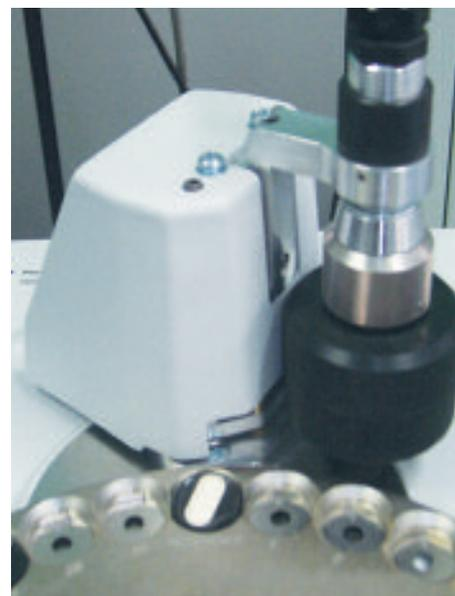
Particolare del rivelatore esterno InGaAs, operante in trasmissione (in primo piano la compressa e il suo adattatore che viene modellato sul campione)
