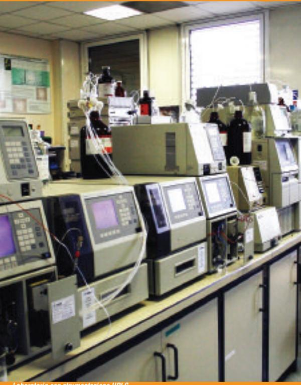
Laboratorio con strumentazione HPLC
