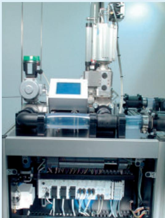
**Il terminale elettrico modulare CPX in combinazione con l'unità di valvole modulare MPA**
