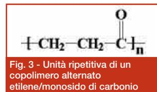
Fig. 3 - Unità ripetitiva di un copolimero alternato etilene/monossido di carbonio
