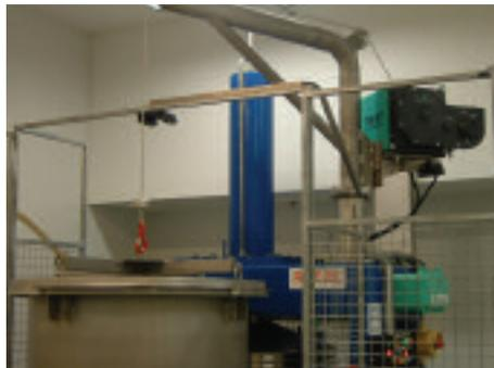
**V**erlinde Technologies ha installato presso i Laboratoires Pharmaceutiques Arkopharma un verricello ultra compatto certificato ATEX per gas e polveri, di 600 kg di portata, derivato dalla gamma Tirlift. Per la società farmaceutica era, infatti, necessario sostituire le apparecchiature di sollevamento che servono per smaltire i residui vegetali in uscita dalla pressa per la fabbricazione di prodotti di fitoterapia.
