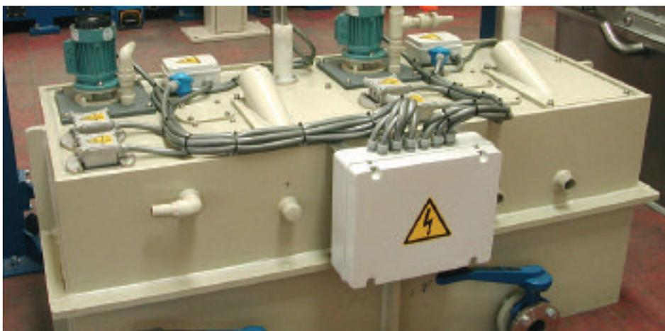
Vasca di raccolta di liquidi corrosivi di un impianto di trattamento delle superfici su cui sono installate pompe verticali
