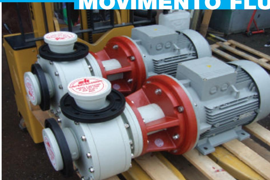
Da anni sul mercato nel settore delle pompe centrifughe in materiali termoplastici (PP, PVC, PVDF, PE-HD), **Savino Barbera** è in grado di proporre anche altri prodotti a completamento della sua gamma di attrezzature anti-corrosione per il trattamento delle acque reflue industriali
