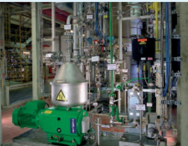
Separatore a dischi ATEX per Biodiesel
