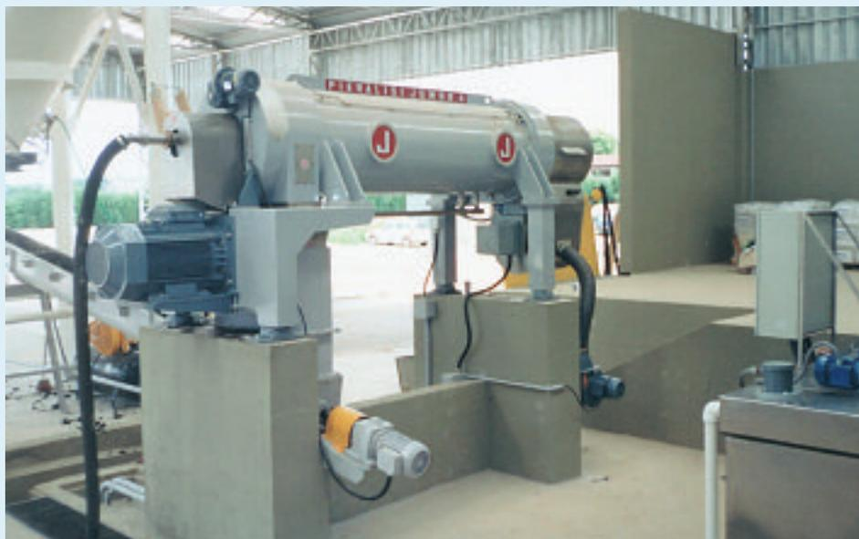
Estrattore centrifugo epr fanghi
