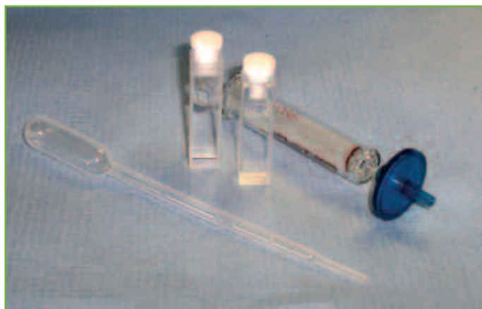
Fig. 4 - Le cuvette in vetro utilizzate per le misure
