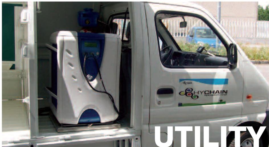
*Realizzato da Air Liquide il prototipo dell'Utility Vehicle funzionante a idrogeno e Fuel Cell che aprirà le porte ad un utilizzo di massa dell'idrogeno*
