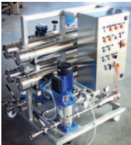
*Impianto di osmosi inversa a spirale avvolta per la produzione di acqua purificata*
