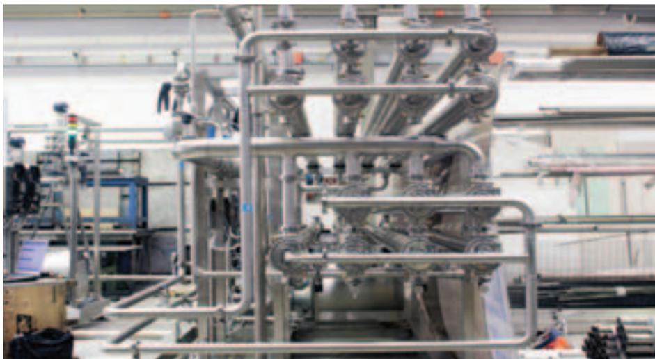
**Impianto per la concentrazione e recupero di prodotti ad alto valore aggiunto con membrane polimeriche**
