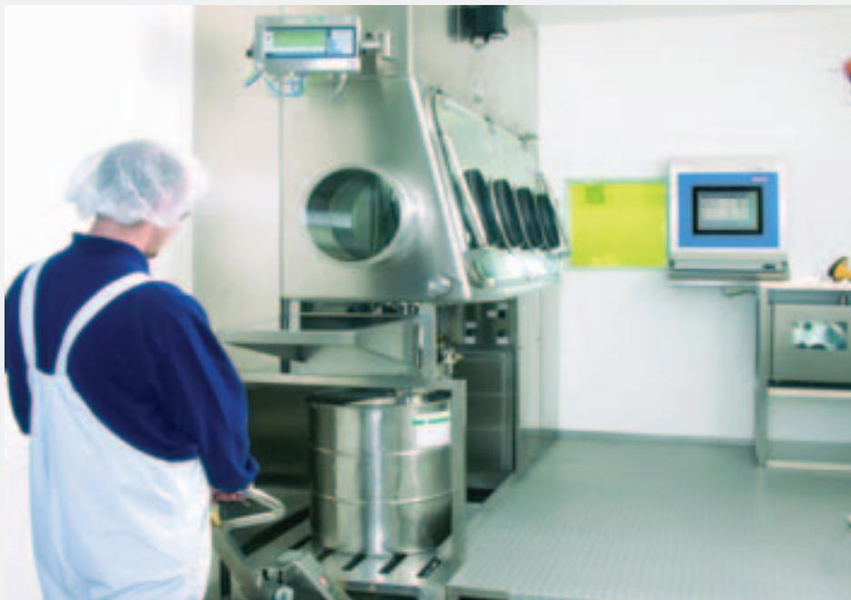
*Impianto di riempimento in zona a rischio: i fusti vengono posizionati sul ricettore di carico che si trova al di sotto della zona a rischio, ma è collegato al terminale Bizerba ST-Ex; il terminale controlla l'intero processo di pesatura e dosaggio trasmettendo i dati al sistema informatico.*
