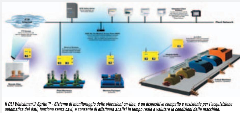
Il DLI Watchman@Sprite™ - Sistema di monitoraggio delle vibrazioni on-line, è un dispositivo compatto e resistente per l'acquisizione automatica dei dati, funziona senza cavi, e consente di effettuare analisi in tempo reale e valutare le condizioni delle macchine.
