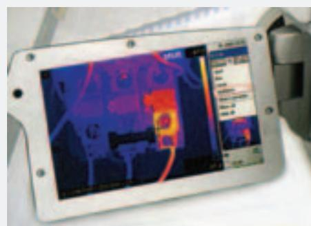
ThermaCAM P640 contiene quattro strumenti: telecamera infrarossi, videocamera nel visibile, illuminatore per l'oggetto inquadrato, puntatore laser
