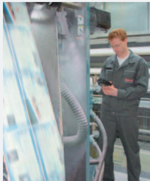
*Il Condition Monitoring permette di acquisire tutte le informazioni possibili sullo stato di salute dei componenti e di poter così riconoscere con anticipo gli elementi che iniziano a degradarsi.*
