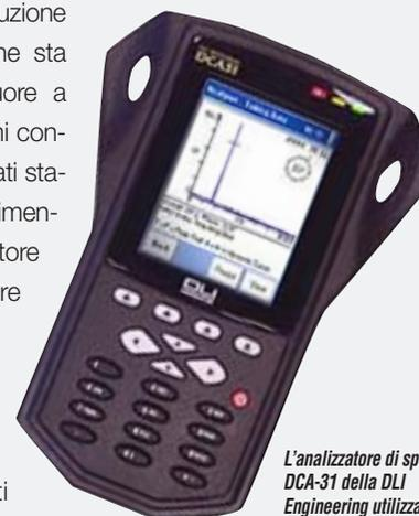
L'analizzatore di spettro DCA-31 della DLI Engineering utilizzato per l'analisi di vibrazioni sugli agitatori
