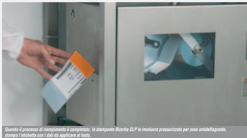
*Quando il processo di riempimento è completato, la stampante Bizerba GLP in involucro pressurizzato per zona antideflagrante, stampa l'etichetta con i dati da applicare al fusto.*
