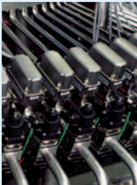
Misuratori di portata magnetici per riempimento volumetrico BatchFlux 5015
