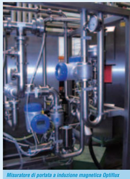
Misuratore di portata a induzione magnetica Optiflux
