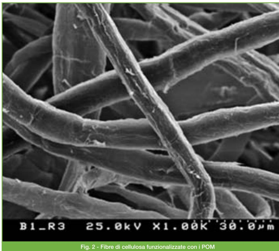
Fig. 2 - Fibre di cellulosa funzionalizzate con i POM
