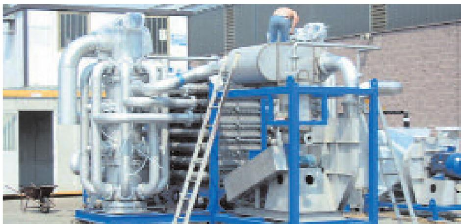
**Impianto pilota adsorbimento 10.000 m³/h in fase di montaggio**
