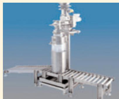
Riempimento di sacchi e di fusti con tecnologia a tubo gonfiante OEB 1 e 2 / OEL 100 fino a <math>5000 \mu\text{g}/\text{m}^3</math>
