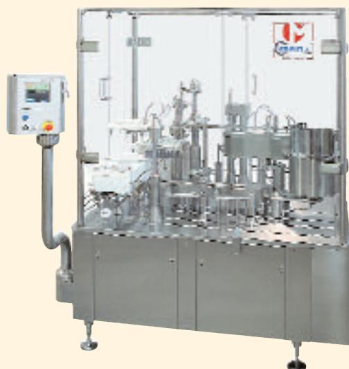
La riempitrice FSP2-E è utilizzata per il riempimento di siringhe monouso
