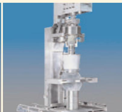
Riempimento e svuotamento di fusti con film infinito OEB 4 / 5 / OEL <math>< 1-10 \mu\text{g}/\text{m}^3</math>
