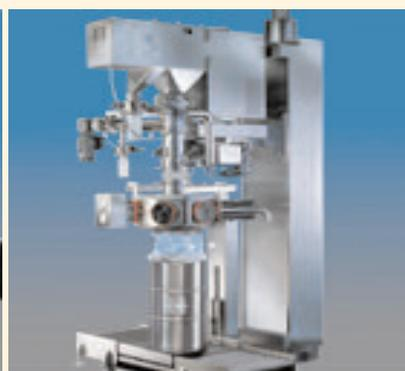
Riempimento e svuotamento di fusti con il sistema Drum-Containment (DCS) OEB 5 / OEL <math>< 1 \mu\text{g}/\text{m}^3</math>
