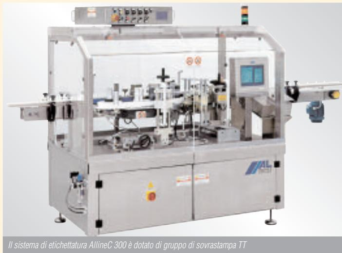
Il sistema di etichettatura AllineC 300 è dotato di gruppo di sovrastampa TT
