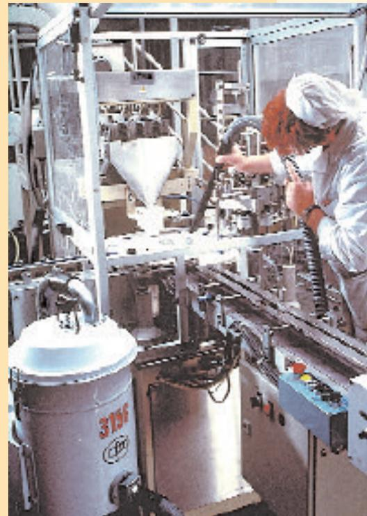
L'aspiratore industriale modello 3156 di CFM è abilitato ad operare nella zone polvere 21 e 22 e nelle zone gas 1 e 2
