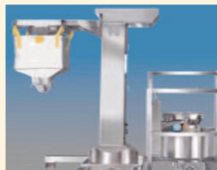
Svuotamento dei Big Bags con sistema di erogazione e di collegamento OEB 1 / OEL 1000 fino a <math>5000 \mu\text{g}/\text{m}^3</math>
