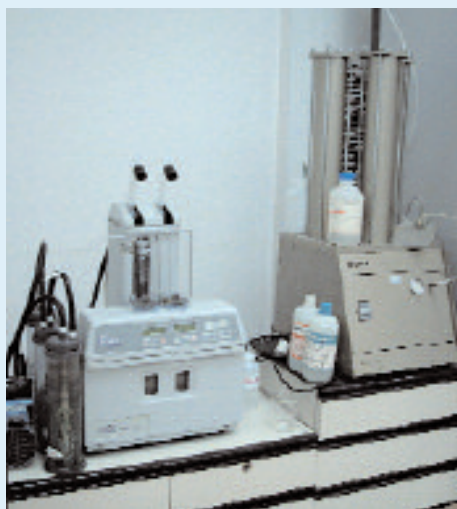
Laboratorio: in primo piano, il mineralizzatore a microonde CEM Star System 2; in secondo piano, il generatore di azoto Nitrox
